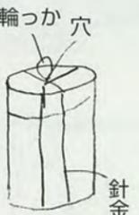
フタの中央部分に小さな穴を開けます。釘と金づちで簡単に開きます。次にかにフタをかぶせて針金を縦に2回ほど巻いてフタがはずれないようにします。フタの中央部分に輪っかを作っておくと後の作業が楽になります。これで準備OK。
